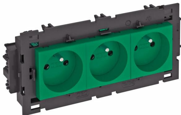
Erdungstift-Steckdose mit seitlichem Anschluss 3-fach 0°, mit erhöhtem Berührungsschutz, mit Steckklemmen, 2-polig, 16 A, 250 V~, mit Verbindungsklemmen nach IEC 60884-1, geeignet für den Einbau in Geräteeinbau-Kanalsysteme Rapid 80.
