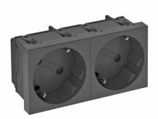
Schutzkontakt-Steckdose 2-fach 33°, mit erhöhtem Berührungsschutz, mit Steckklemmen, 2-polig, 16 A, 250 V~, mit Verbindungsklemmen nach IEC 60884-1.
