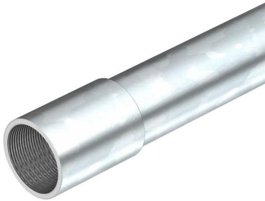
Elektroinstallationsrohr nach EN 61386-1, mit Gewindeenden nach DIN EN 60423, für den mechanischen Schutz von Kabeln und Leitungen. Mit gratfreier Innenwand. Korrosionsschutzklasse 2 (mittel). Pro Rohr ist bereits eine Verbindungsmuffe aufgeschraubt.
