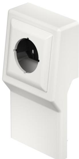
Geräteträger leer für den Sockelleistenkanal zum Einbau von Standardgeräten in Tragrings- und Tragbügelbauweise mit 60-mm-Befestigungsspur. Zum Aufrasten auf das Unterteil des Kanalsystems.
