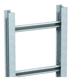
Industrie-Steigeleiter-System für den elektrischen Funktionserhalt nach DIN 4102 Teil 12. Zugelassene Schellen Typ BS-U1-M-... FT. Lieferung erfolgt unmontiert. Sprossenabstand 300 mm. Sprossen Typ CK 40/... und Schrauben Typ FRS 10 x 25 FT werden zu Holmprofilen unmontiert geliefert.
