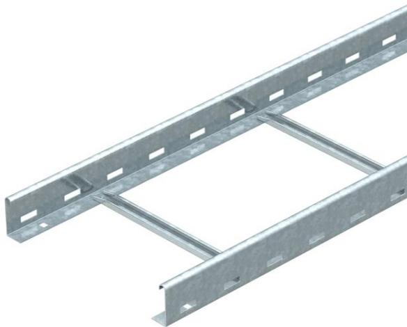
Kabelleiter in Seitenhöhe 60 mm mit eingeneteten, nach oben offenen C- Profil Sprossen. Eingerollter Seitenholm zur Verstärkung und als Kantenschutz. Die Befestigung auf dem Ausleger erfolgt mit Klemmstücken Typ LKS 40. Das Schlitzmaß der Sprosse beträgt 11 mm, die passende Bügelschelle ist der Typ 2056/ N. Magnetische Schirmdämpfung ohne Deckel 10 dB, mit Deckel 15 dB.
