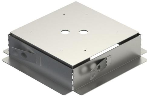
Überschleifbarer Schalkörper zum direkten und fugenlosen Einbau von nivellierbaren Kassetten, Nenngröße 4, in oberflächenfertige Estriche/Terrazzo-Böden. Die Schalung wird schwimmend auf Unterflurdosen mit Montagedeckel Nenngröße 4 aufgelegt und schließt die Freiräume zwischen Unterflurdose und Kassettenrahmen.
