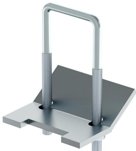
Verbindungselement zur beidseitigen Befestigung von Profilschienen an Stahlträgern. Die Befestigung ist unabhängig von der Anordnung der Schienenöffnung möglich. Die Schienenlänge sollte mindestens die Breite des Stahlträgers + 2 x 50 mm betragen.
