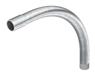
90°-Bogen für Elektroinstallationsrohre nach EN 61386-1 mit Gewindeenden nach DIN EN 60423. Mit gratfreier Innenwand.
