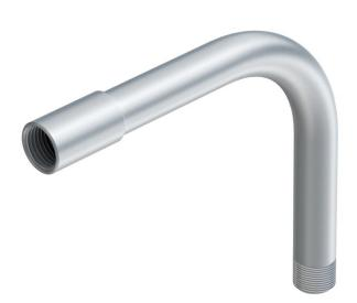
90°-Bogen für Elektroinstallationsrohre nach EN 61386-1 mit Gewindeenden nach DIN EN 60423. Mit gratfreier Innenwand. Pro Rohrbogen ist bereits eine Verbindungsmuffe aufgeschraubt.
