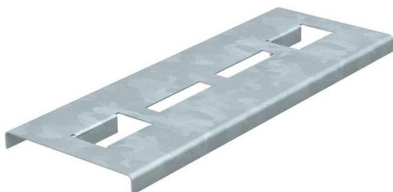
Sprossenauflegebleche zur Vergrößerung der Auflagefläche für die Kabel in den Formteilen für die Verlegearten mit Kabelleitern zum Funktionserhalt nach DIN 4102 Teil 12. Damit die Funktionserhaltskabel im Brandfall eine möglichst große Auflagefläche in den Kabelleiterformteilen haben, sind zusätzlich die Sprossenauflegebleche zu verwenden. Die Sprossenauflegebleche werden nur lose auf die Sprossen der Kabelleiterformteile gelegt. Die nach unten ausgebildeten Nasen verhindern ein Wegrutschen.
