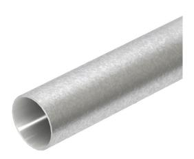
Elektroinstallationsrohr ohne Gewindeenden nach EN 61386-1, für den mechanischen Schutz von Kabeln und Leitungen. Mit gratfreier Innenwand. Korrosionsschutzklasse 4 (hoch).
