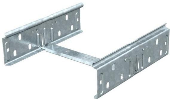
Schnellverbinder-Set für gerade, schraubenlose Verbindung von Kabelrinnen und Formteilen mit der Seitenhöhe 60 mm. Die durchgängige Schutzleiterverbindung ist ohne Schraubverbindung gewährleistet.
