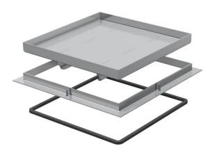
Rahmenkassette Schwerlast "blind" für die Herstellung einer Revisionsöffnung in der UZD250-3 in trocken oder nass gepflegten Fußböden. Belastungsklasse 2 bis 20 kN. Nur für glatte Bodenbeläge im Innenbereich geeignet.
