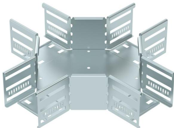
Kreuzung zum Erstellen einer horizontalen Abzweigung, Formteil für rast- und schraubbare Kabelrinnen Seitenhöhe 85 mm. Schraubenlose Montage mit Doppelklemmen oder Schraubverbindung mit Flachrundschrauben FRS und Kombimuttern M6. Einsetzbar im Innenbereich. Befestigungsmaterial muss separat bestellt werden.
