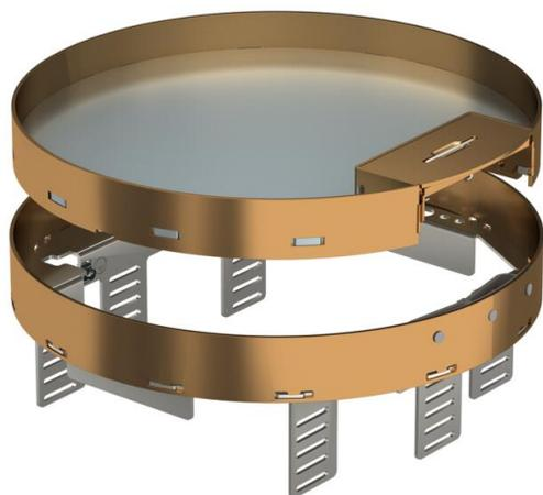
Nivellierbare und vom Fußboden entkoppelte Kassette der Nenngröße R7 mit Schnuraustritt, für den Einbau von Installationsgeräten in trocken gepflegten Fußböden im Innenbereich, zur Montage in Unterflurdosen UZD350-3 in Verbindung mit einem Montagedeckel DUG350-3R7 oder in UGD350-3R7. Die Montage erfolgt mittels Nivellierwinkeln (separat bestellen) im Aluminium-Rahmenprofil der Unterflurdosen.
