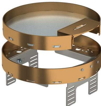
Nivellierbare und vom Fußboden entkoppelte Kassette der Nenngröße R4 mit Schnuraustritt, für den Einbau von Installationsgeräten in trocken gepflegten im Innenbereich, zur Montage in Unterflurdosen UZD250-3 oder UZD350-3, jeweils in Verbindung mit einem Montagedeckel DUG..R4 oder in UGD250-3R4 oder UGD350-3R4. Die Montage erfolgt mittels Nivellierwinkeln (separat bestellen) im Aluminium-Rahmenprofil der Unterflurdosen.
