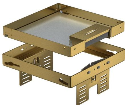
Nivellierbare und vom Fußboden entkoppelte Kassette der Nenngröße 4, mit Schnuraustritt, für den Einbau von Installationsgeräten in trocken gepflegten Fußböden im Innenbereich, zur Montage in Unterflurdosen UZD250-3 oder UZD350-3, jeweils in Verbindung mit einem Montagedeckel DUG../4 oder in UGD250-3/4 oder UGD350-3/4. Die Montage erfolgt mittels Nivellierwinkel (separat bestellen) im Aluminium-Rahmenprofil der Unterflurdosen.
