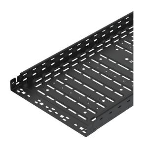
Kabelrinne mit integriertem Schnellbefestigungssystem. Bandverzinkte Oberfläche, Sichtflächen pulverbeschichtet in tiefschwarz (RAL 9005). Durchgängige Seitenlochung von 7 x 20 mm für die Installation zusätzlicher Verbindungs- und Montagebauteile. Mit 11-mm-Lochung im Boden für die direkte Gewindestangenabhängung. Nutzlänge 3.000 mm.
