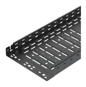
Kabelrinne mit integriertem Schnellbefestigungssystem. Bandverzinkte Oberfläche, Sichtflächen pulverbeschichtet in tiefschwarz (RAL 9005). Durchgängige Seitenlochung von 7 x 20 mm für die Installation zusätzlicher Verbindungs- und Montagebauteile. Mit 11-mm-Lochung im Boden für die direkte Gewindestangenabhängung. Nutzlänge 3.000 mm.
