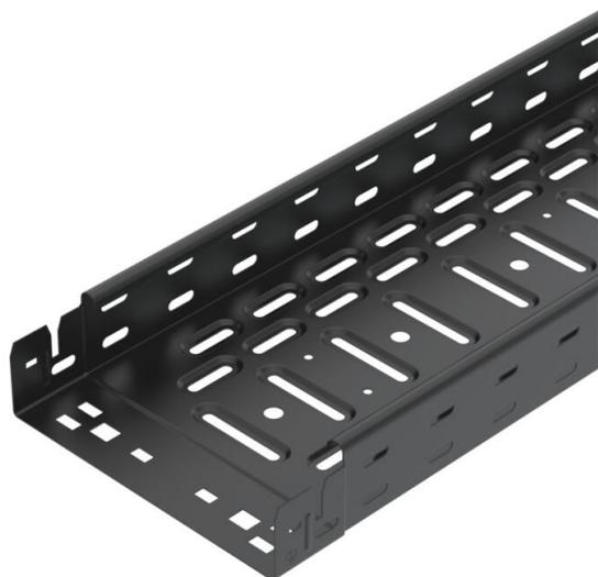
Kabelrinne mit integriertem Schnellbefestigungssystem. Bandverzinkte Oberfläche, Sichtflächen pulverbeschichtet in tiefschwarz (RAL 9005). Durchgängige Seitenlochung von 7 x 20 mm für die Installation zusätzlicher Verbindungs- und Montagebauteile. Mit 11-mm-Lochung im Boden für die direkte Gewindestangen-abhängung. Nutzlänge 3.000 mm.
