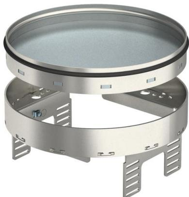
Nivellierbare und vom Fußboden entkoppelte Kassette "blind" für die Herstellung einer Revisionsöffnung der Nenngröße R4 in trocken oder nass gepflegten Fußböden im Innenbereich, zur Montage in Unterflurdosen UZD250-3 oder UZD350-3, jeweils in Verbindung mit einem Montagendeckel DUG..R4 oder in UGD250-3R4 oder UGD350-3R4. Die Montage erfolgt mittels Nivellierwinkel (separat bestellen) im Aluminium-Rahmenprofil der Unterflurdosen. Nur für glatte Bodenbeläge geeignet.
