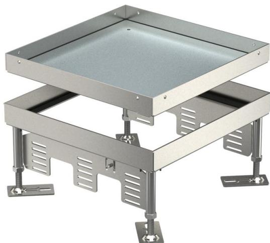
Quadratische Kassette Schwerlast "blind" in Nenngröße 9 für die Herstellung einer Revisionsöffnung in Kanalsystemen, Doppel- und Hohlböden, in trocken oder nass gepflegten Fußböden im Innenbereich. Belastungsklasse 1 bis 10 kN. Nur für glatte Bodenbeläge geeignet.
