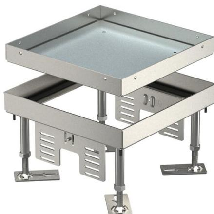
Quadratische Kassette Schwerlast "blind" in Nenngröße 4 für die Herstellung einer Revisionsöffnung in Kanalsystemen, Doppel- und Hohlböden, in trocken oder nass gepflegten Fußböden im Innenbereich. Belastungsklasse 1 bis 10 kN. Nur für glatte Bodenbeläge geeignet.
