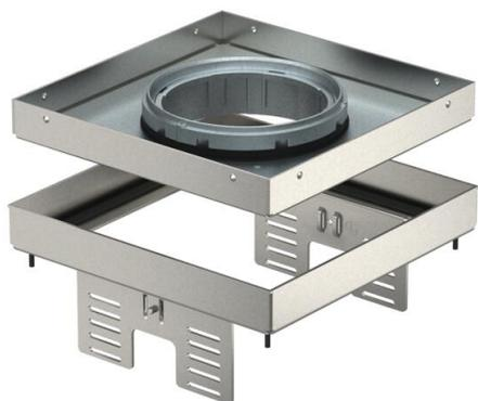
Nivellierbare und vom Fußboden entkoppelte Kassette der Nenngröße 4, für Tubus, für den Einbau von Installationsgeräten in trocken oder nass gepflegten Fußböden im Innenbereich, zur Montage in Unterflurdosen UZD250-3 oder UZD350-3, jeweils in Verbindung mit einem Montagedeckel DUG../4 oder in UGD250-3/4 oder UGD350-3/4. Die Montage erfolgt mittels Nivellierwinkeln (separat bestellen) im Aluminium-Rahmenprofil der Unterflurdosen.
