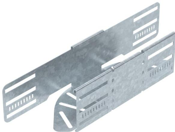
Winkelverstellbarer Bogen zum Erstellen einer horizontalen Abzweigung. Formteil für rast- und schraubbare Kabelrinnen Seitenhöhe 85 mm. Einstellbarer Winkel 0 - 90°. Schraubenlose Montage mit Doppelklemmen oder Schraubverbindung mit Flachrundschrauben FRS und Kombimuttern M6. Einsetzbar im Innen- und Außenbereich. Befestigungsmaterial muss separat bestellt werden.
