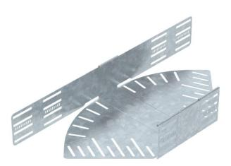
Winkelverstellbarer Bogen zum Erstellen einer horizontalen Abzweigung, Formteil für rast- und schraubbare Kabelrinnen Seitenhöhe 110 mm. Einstellbarer Winkel 0 - 90°. Schraubenlose Montage mit Doppelklemmen oder Schraubverbindung mit Flachrundschrauben FRS und Kombimuttern M6. Einsetzbar im Innen-und Außenbereich. Befestigungsmaterial muss separat bestellt werden.
