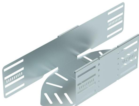
Winkelverstellbarer Bogen zum Erstellen einer horizontalen Abzweigung. Formteil für rast- und schraubbare Kabelrinnen Seitenhöhe 110 mm. Einstellbarer Winkel 0 - 90°. Schraubenlose Montage mit Doppelklemmen oder Schraubverbindung mit Flachrundschrauben FRS und Kombimuttern M6. Einsetzbar im Innenbereich. Befestigungsmaterial muss separat bestellt werden.
