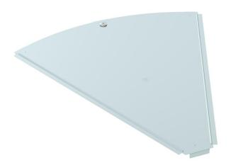
Deckel für Formteil Bogen 45° für rastbare und schraubbare Kabelrinnen im Innenbereich, zum Schutz der Kabel vor Beschädigungen und Schmutz. Befestigung mit vormontiertem Drehriegel und durch Auflage des Streckendeckels. Passend für alle Seitenhöhen.
