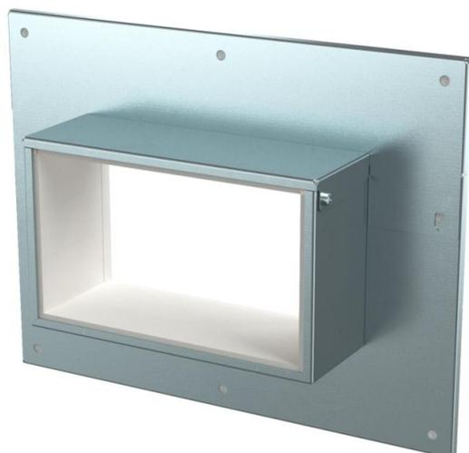
Wandanschlusskragen, 4-seitig mit integrierter Dichtung für Installationskanal PYROLINE® Rapid PLM. Zur Montage im Bereich von Wand- und Deckenanschlüssen sowie Wanddurchführungen. Auch als 3-seitiger Wandanschlusskragen bei direkter Wand- oder Deckenmontage des Kanals einsetzbar.
