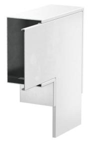
Flachwinkel mit intumeszierendem Brandschutzgewebe für Installationskanal PY-ROLINE® Rapid PLM. Geeignet für die direkte Wand- und Deckenmontage, Montage unterhalb von Systemböden und auf Tragsystemen. Werkzeuglose Stoßstellenmontage mit Stoßstellenverbinder PLM SI. Der Deckel wird werkzeuglos aufgerastet und ermöglicht eine schnelle Revision und Nachbelegung. Deckelüberstand ermöglicht versetzte Deckelmontage für durchgängigen Potentialausgleich der gesamten Kanalstrecke.
