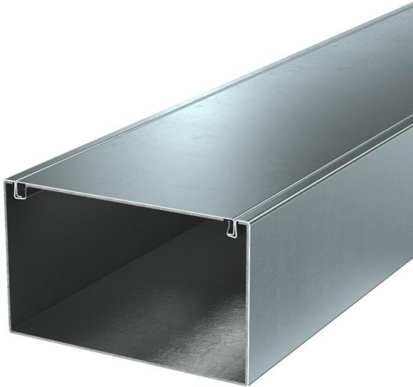
Installationskanal aus Metall mit intumeszierendem Brandschutzgewebe zur brandsicheren Verlegung von Kabeln. Klassifiziert als Installationskanal EI30, EI60 und EI90 gemäß EN 13501-2, geprüft nach EN 1366-5. Der Kanal verhindert über den klassifizierten Zeitraum die Brandweiterleitung und schützt vor den Auswirkungen eines Kabelbrandes.
