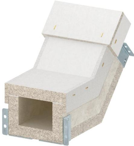
Vertikalbogen steigend für Brandschutzkanal PYROLINE® Con S EI60, Typ PLCS D060810 bestehend aus wasser- und frostbeständigem Glasfaserleichtbeton zur Herstellung von vertikalen Richtungsänderungen (45°) im Kanalverlauf. Fertig montierte Verbindungsbeschläge sorgen für eine schnelle Montage vor Ort, lose aufgelegte Deckel für eine schnelle Revision und Nachbelegung. Inklusive Verbindungsschrauben und Dichtungsstreifen.
