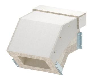
Vertikalbogen fallend für Brandschutzkanal PYROLINE® Con S El90, Typ PLCS D091220 bestehend aus wasser- und frostbeständigem Glasfaserleichtbeton zur Herstellung von vertikalen Richtungsänderungen (45°) im Kanalverlauf. Fertig montierte Verbindungsbeschläge sorgen für eine schnelle Montage vor Ort, lose aufgelegte Deckel für eine schnelle Revision und Nachbelegung. Inklusive Verbindungsschrauben und Dichtungsstreifen. Inklusive Verbindungsschrauben und Dichtungsstreifen.
