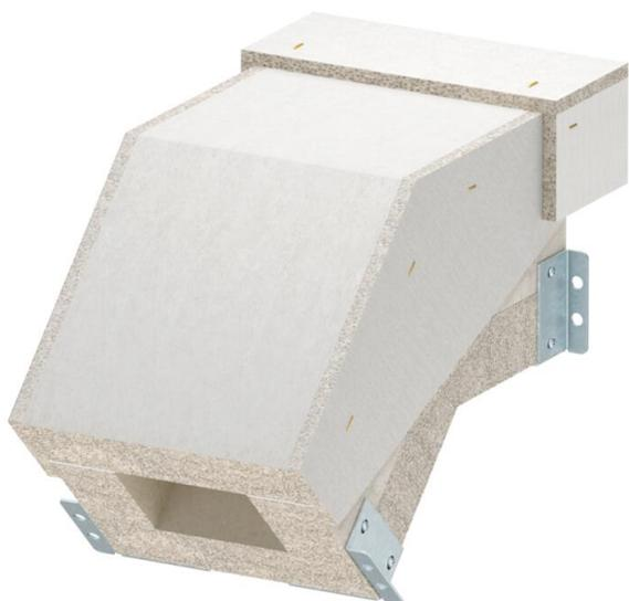
Vertikalbogen fallend für Brandschutzkanal PYROLINE® Con S EI90, Typ PLCS D090810 bestehend aus wasser- und frostbeständigem Glasfaserleichtbeton zur Herstellung von vertikalen Richtungsänderungen (45°) im Kanalverlauf. Fertig montierte Verbindungsbeschläge sorgen für eine schnelle Montage vor Ort, lose aufgelegte Deckel für eine schnelle Revision und Nachbelegung.
