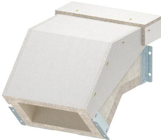
Vertikalbogen fallend für Brandschutzkanal PYROLINE® Con S EI60, Typ PLCS D061220 bestehend aus wasser- und frostbeständigem Glasfaserleichtbeton zur Herstellung von vertikalen Richtungsänderungen (45°) im Kanalverlauf. Fertig montierte Verbindungsbeschläge sorgen für eine schnelle Montage vor Ort, lose aufgelegte Deckel für eine schnelle Revision und Nachbelegung.
