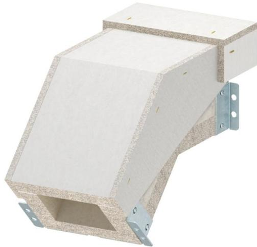
Vertikalbogen fallend für Brandschutzkanal PYROLINE® Con S EI60, Typ PLCS D060810 bestehend aus wasser- und frostbeständigem Glasfaserleichtbeton zur Herstellung von vertikalen Richtungsänderungen (45°) im Kanalverlauf. Fertig montierte Verbindungsbeschläge sorgen für eine schnelle Montage vor Ort, lose aufgelegte Deckel für eine schnelle Revision und Nachbelegung.
