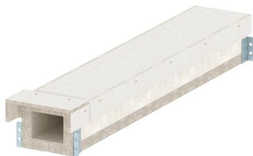
Brandschutzkanal aus wasser- und frostbeständigem Glasfaserleichtbeton der Baustoffklasse A1 gemäß EN 13501-1 zur brandsicheren Verlegung von Kabeln in Flucht- und Rettungswegen. Klassifizierung EI30 - EI60 als Installationskanal gemäß EN 13501-2 auf Basis von Prüfungen gemäß EN 1366-5. Der Kanal verhindert bei einer Brandbelastung von innen (Kabelbrand) die Brandausbreitung von einem Brandabschnitt auf einen anderen.
