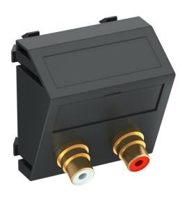
Multimediaträger mit zwei Cinch Anschlussbuchsen für Audio R / L, Kabelauslass schräg, mit Beschriftungsfeld, zwei Cinch Buchsen (RCA) mit Lötanschluss, Farbkodierung rot / weiß. Trägerplatte mit Rastbefestigung, geeignet für den waagerechten und senkrechten Einbau in die Systemumgebung.
