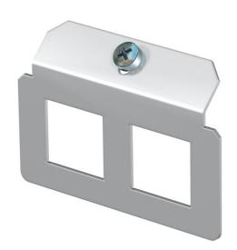
Trägerplatte zur Aufnahme von zwei Anschlussbuchsen der Datentechnik, Typ Panduit in Verbindung mit Panduit-Adapter CMNZABL-X oder CMNZAWH-X. Abmessung einer Montageöffnung in mm: 19,8 x 21,2.
