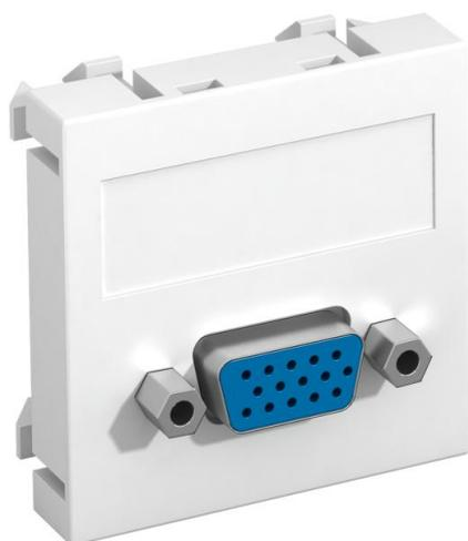
Multimediaträger mit einer VGA-Anschlussbuchse, Kabelauslass gerade, mit Beschriftungsfeld, VGA-Buchse (HD15) mit Schraubanschluss. Trägerplatte mit Rastbefestigung, geeignet für den waagerechten und senkrechten Einbau in die Systemumgebung.
