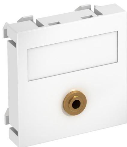
Multimediaträger mit einer Mini-Klinken-Anschlussbuchse, Kabelauslass gerade, mit Beschriftungsfeld, Mini-Klinken-Buchse (TRS 3,5 mm) mit Lötanschluss. Trägerplatte mit Rastbefestigung, geeignet für den waagerechten und senkrechten Einbau in die Systemumgebung.
