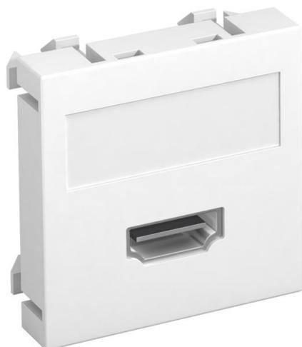
Multimediaträger mit einer HDMI-Anschlussbuchse, Kabelauslass gerade, mit Beschriftungsfeld, HDMI-Buchse mit Schraubanschluss. Trägerplatte mit Rastbefestigung, geeignet für den waagerechten und senkrechten Einbau in die Systemumgebung.
