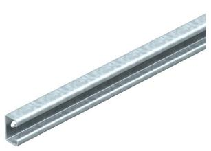
Profilschiene MS4022 für den Einsatz als Sprosse in schwerer Steigeleiter. Maximale Sprossenbelastung 175 kg. Die passende Bügelschelle ist der Typ 2056U.
