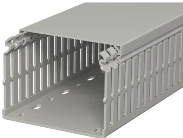
Verdrahtungskanal nach DIN EN 50085-2-3 inkl. Oberteil und Bodenlochung zur waagerechten und senkrechten Verlegung elektrischer Kabel und Leitungen im Schaltschrank. Ausführung als DIN-Kanal. Das Ausbrechen der Stege erfolgt werkzeuglos. Bodenbündiges Ausführen ist durch Sollbruchstellen möglich. Verjüngungen in den Seitenschlitz verhindern das Herausfallen der Leitungen. Geprüft nach DIN EN 50085-2-3. Sonderlängen auf Anfrage.
