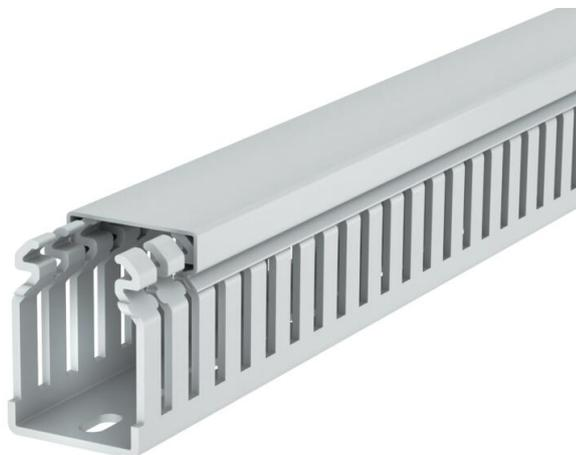
Halogenfreier Verdrahtungskanal nach DIN EN 50085-2-3 inkl. Oberteil und Bodenlochung zur waagerechten und senkrechten Verlegung elektrischer Kabel und Leitungen im Schaltschrank. Ausführung als DIN-Kanal. Das Ausbrechen der Stege erfolgt werkzeuglos. Bodenbündiges Ausführen ist durch Sollbruchstellen möglich. Geprüft nach DIN EN 50085-2-3. Sonderlängen auf Anfrage.
