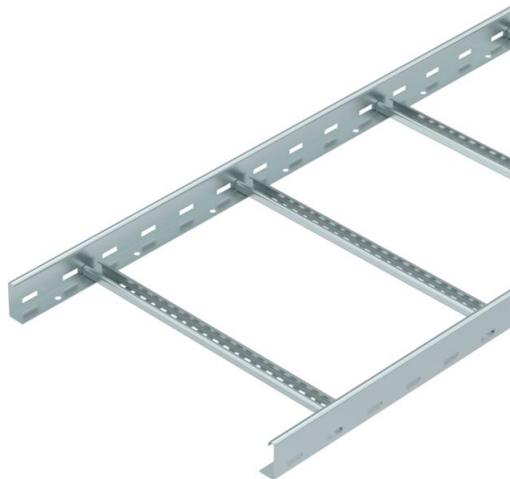
Kabelleiter mit gelochtem Seitenholm in der Seitenhöhe 60 mm mit eingelieteten, nach oben offenen C-Profil-Sprossen (Ausführung VS). Die Kabelleiter wird in zusammengeklappter Ausführung geliefert.
