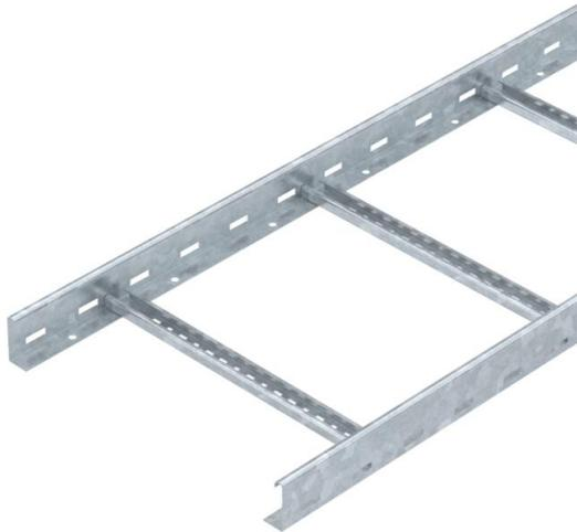
Kabelleiter mit gelochtem Seitenholm in der Seitenhöhe 60 mm mit eingieteten, nach oben offenen C-Profil-Sprossen (Ausführung VS). Die Kabelleiter wird in zusammengeklappter Ausführung geliefert. Die passende Bügelschelle vom Typ 2056 finden Sie im Abgriff Steigleiter-Systeme.
