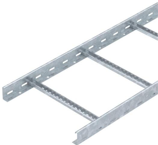
Kabelleiter mit gelochtem Seitenholm in der Seitenhöhe 60 mm mit eingelieteten, nach oben offenen C-Profil-Sprossen (Ausführung VS). Die Kabelleiter wird in zusammengeklappter Ausführung geliefert.
