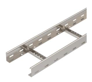
Kabelleiter mit gelochtem Seitenholm in der Seitenhöhe 60 mm mit eingenieteten, nach oben offenen C-Profil-Sprossen (Ausführung VS). Die Kabelleiter wird in zusammengeklappter Ausführung geliefert.
